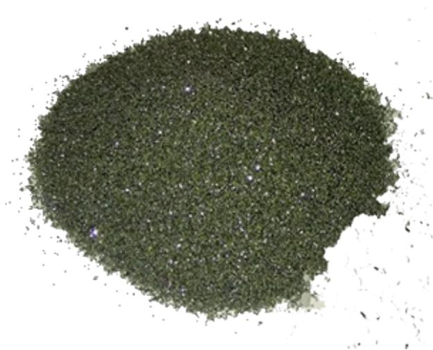
*Зерна алмазов, полученные в данных условиях, представляют собой отдельные несовершенные кристаллы с развитой поверхностью, их сростки и агрегаты.*
